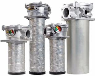
Option de filtre en ligne/retour Parker à haut débit (1700 LPM / 374 GPM) et basse pression (10 BAR / 150 PSI). Conçu pour offrir un contrôle efficace de la contamination et des performances dans les circuits hydrauliques exigeants d'aujourd'hui, la conception du GLF maximise la capacité et la durée de vie de l'élément tout en maintenant une chute de pression faible, même dans des conditions de démarrage à froid.
